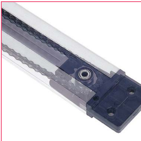
Binario premontato, dove la catena, o la cinghia, e il pignone (su cuscinetti) sono già state montati e tensionati.
